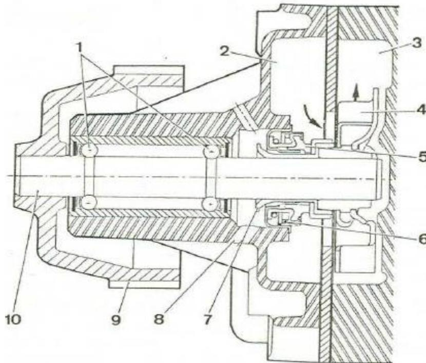
Fig 30 : Pompe à eau "Turbo-Joint"
