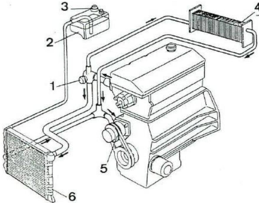
Fig 33 : Circuit du liquide de refroidissement avec dégazage par vase d'expansion
