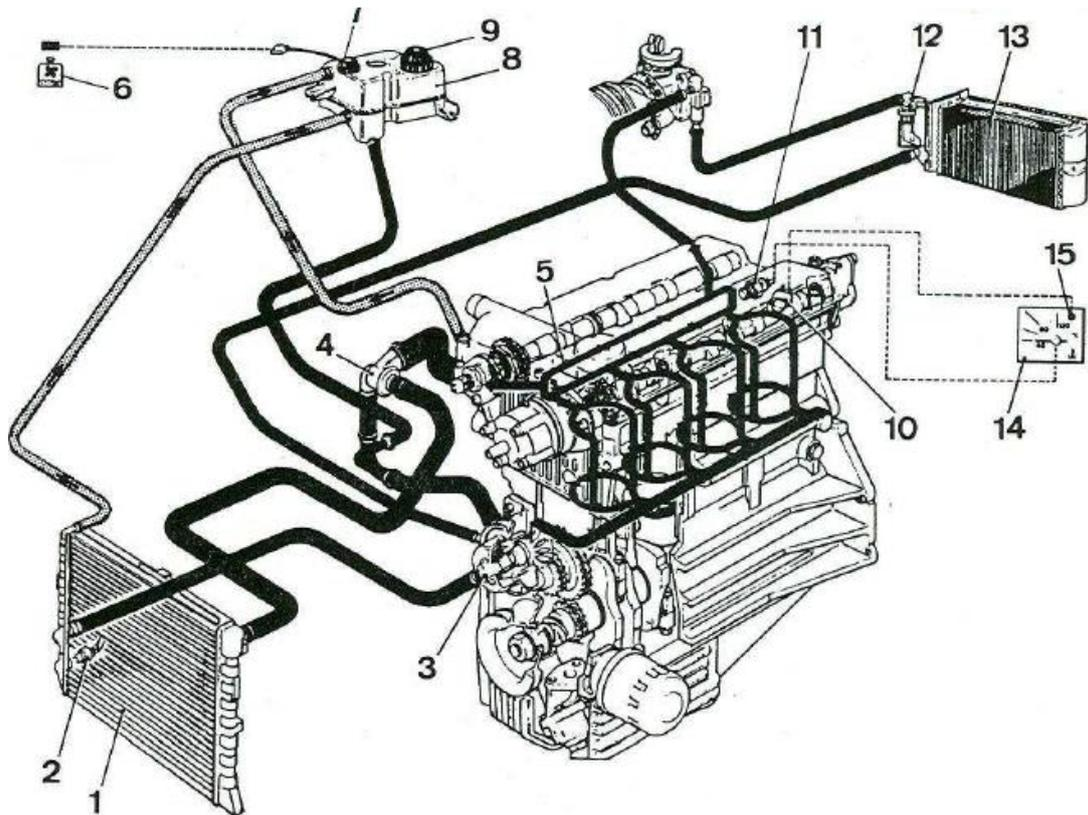
Fig 29 : Circuit de refroidissement d'un moteur
