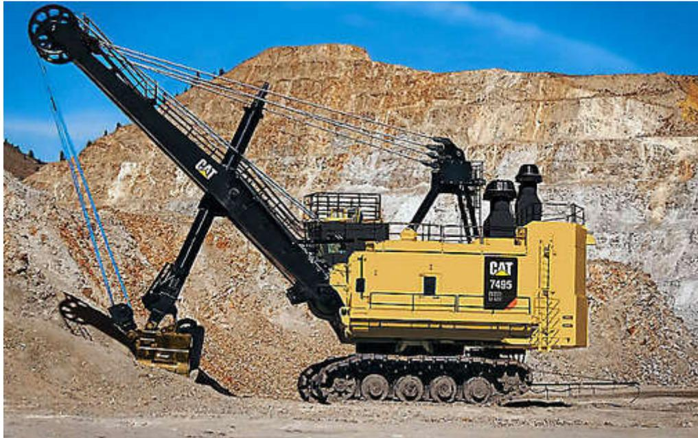
La pelle à câbles a été et reste malgré la montée en puissance des pelles hydraulique l'engin de chargement des grandes mines à ciel ouvert . Pour des pelles de 3 à 30 m<sup>3</sup>de godet il existe sur le marché mondial 8 constructeurs qui proposent environ 40 modèles de poids de 100 à 1500 tonnes . les progrès ont été très rapides durant la dernière décennie.
