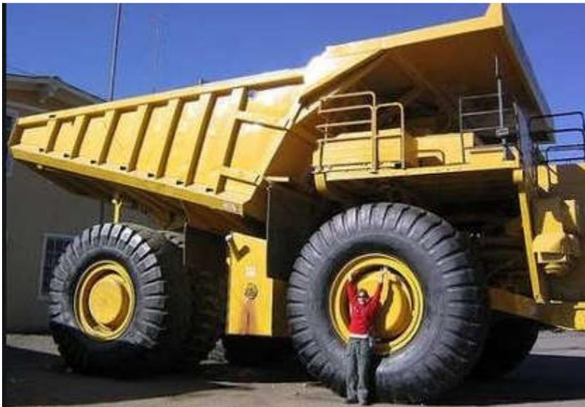
Les tombereaux rigides couramment utilisés en carrière et TP sont des engins à 4 ou 6 roues avec un essieu moteur . Leur capacité utile est très variable , elle va de 25t . à 700 tonnes .
