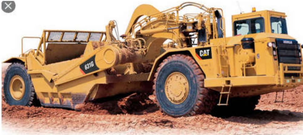
Ces machines réalisant à la fois l'extraction par couche de 20 à 25 cm
