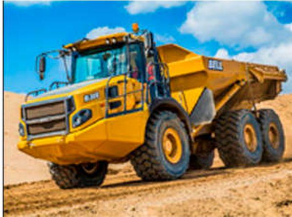
La dernière décennie a vu se développer ce type de matériel en carrière et découverte alors qu'il était jusqu'alors plutôt réservé aux chantiers de TP et aux exploitations souterraines . ils ont en général un châssis articulé oscillant ce qui leur confère une excellente maniabilité et une meilleure adhérence au sol
