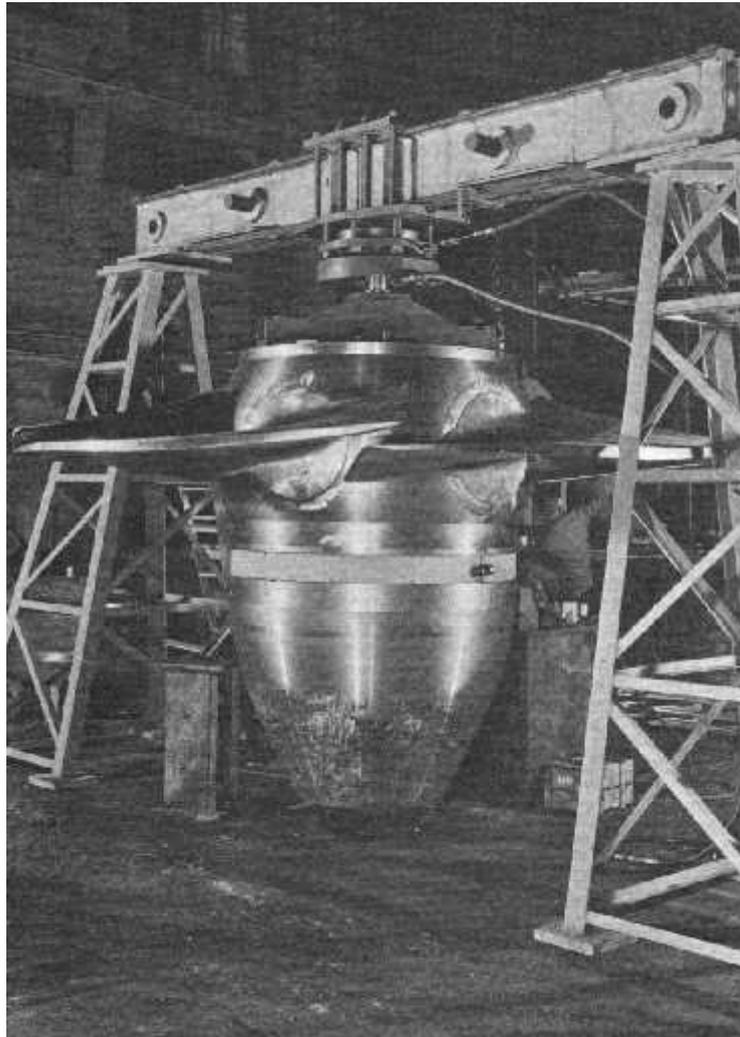
**Fig.6.14** Roue de la turbine Kaplan
