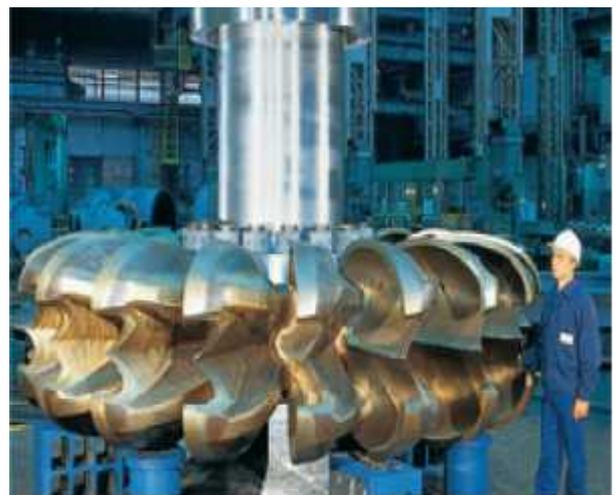
Fig.6.7 Roue de la turbine Pelton
