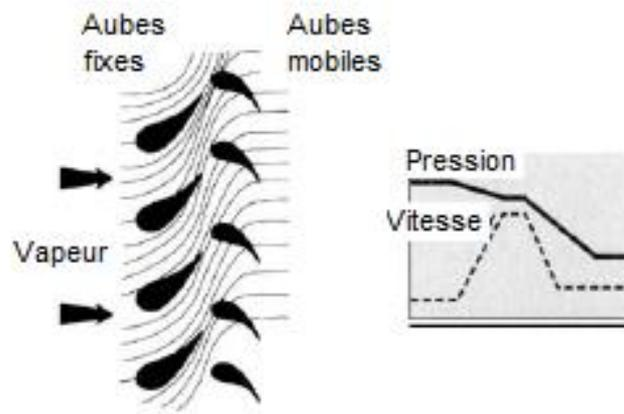
Fig. III.3 Répartition de la vitesse et de la pression dans une turbine à réaction.
