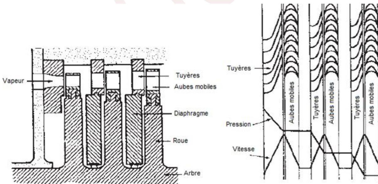
Fig. III.4 Turbine à impulsion type Râteau
