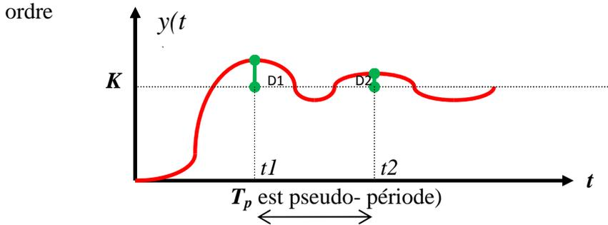
**Figure. 1.53:** Réponse indicielle système du 2<sup>er</sup> ordre.
