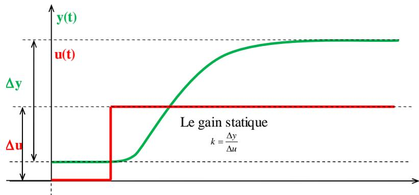
**Figure. 1.52:** Réponse indicielle système du 1<sup>er</sup> ordre sorties =  $f$  (entrée).
