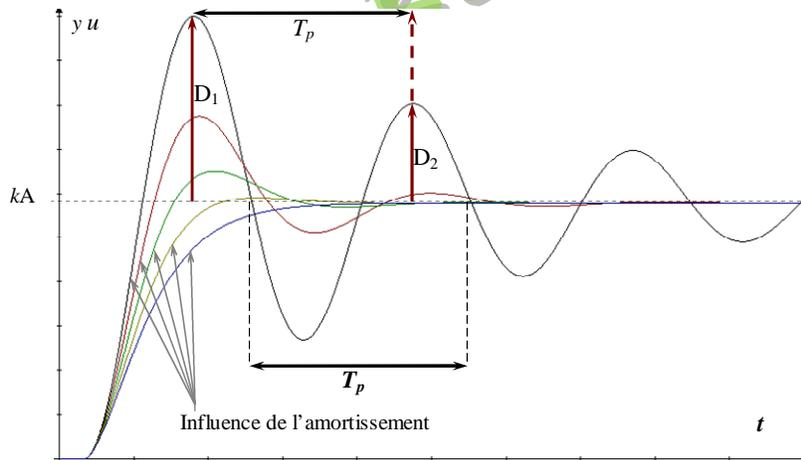
Figure. 1.54: Réponse indicielle système du 2<sup>em</sup> ordre.
