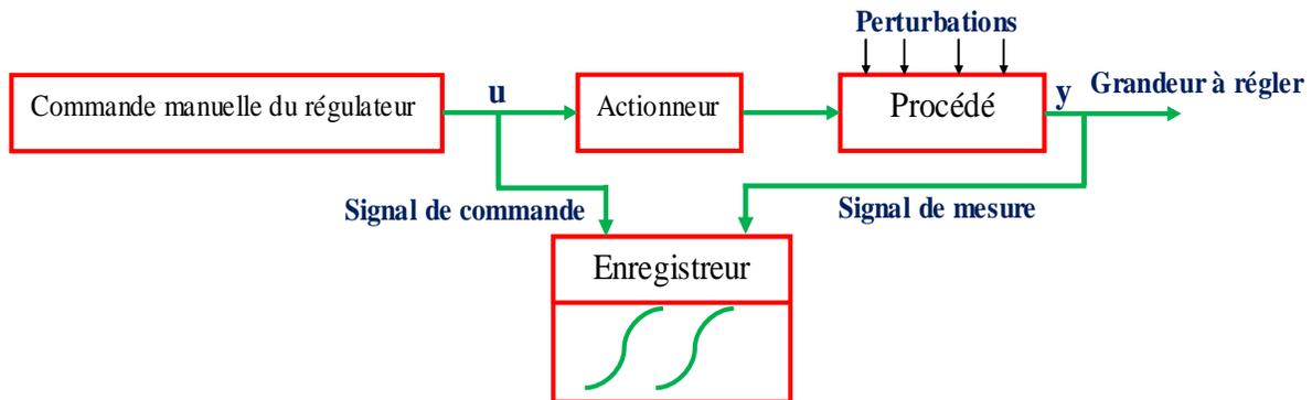
**Figure. 1.47:** Capture (enregistrement) des données en BO.
