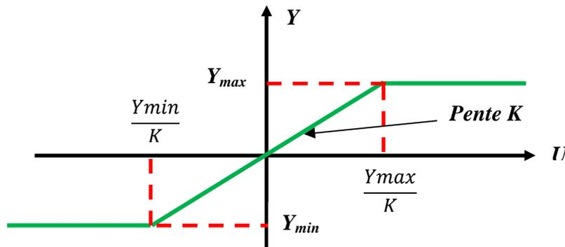
Figure. 1.51: Exemple d'un phénomène de saturation.
