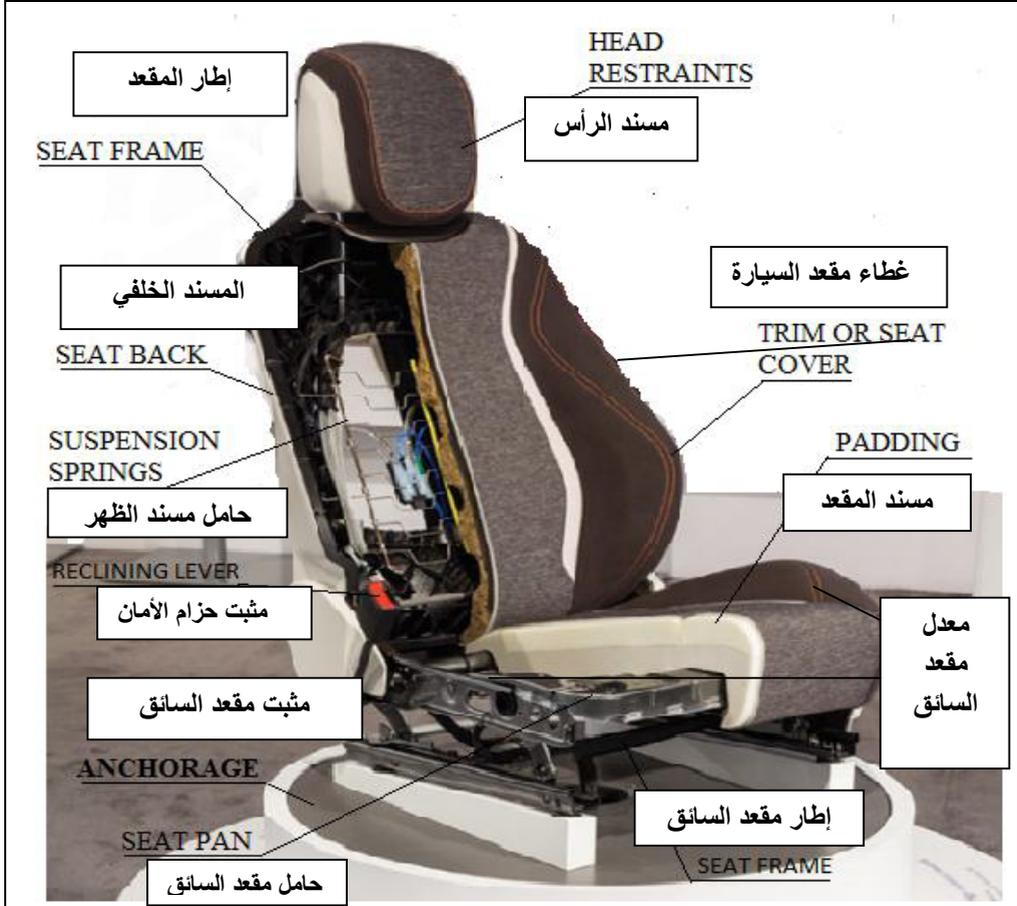
الشكل رقم (01): يوضح مكونات مقعد سائق السيارة
