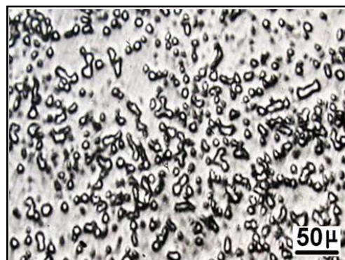
Figure 2: Micrographie d'un acier doté d'une microstructure de sphéroïdale.
