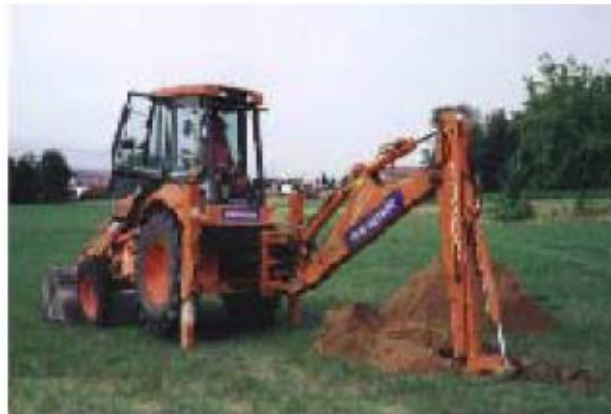
Figure 7. Sondage pédologique à l'aide d'un tracto-pelle
