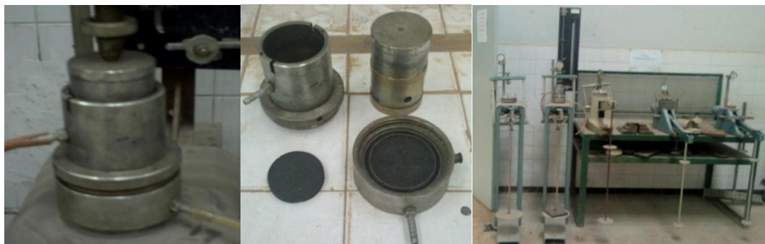
Figure 7. Coupe schématisée du moule oedométrique de Terzaghi
