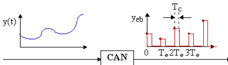
Figure (10) Echantillonneur Bloqueur
