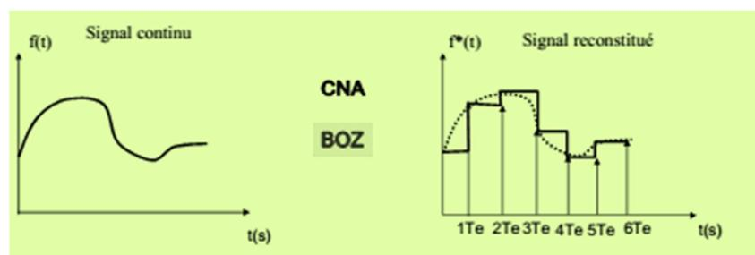
Figure. (5) rôle du CNA i.e BOZ → Reconstruction du signal continu
