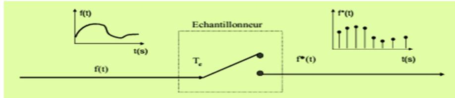
Figure (4) Echantillonneur à pulsation → (peigne de Dirac)
