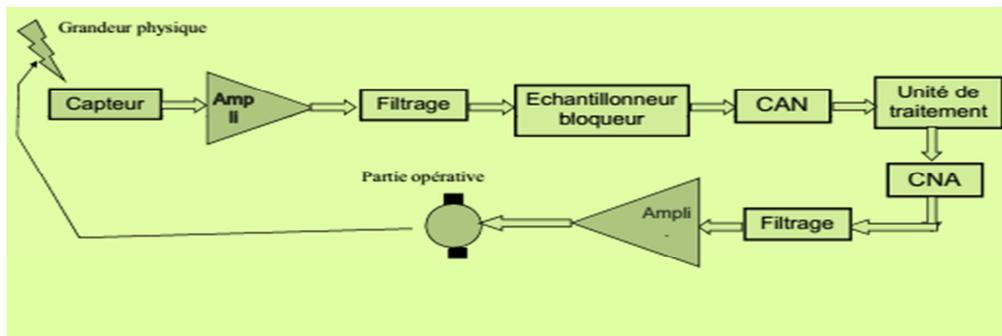
Figure. (9) Schéma de principe d'une boucle de traitement numérique
