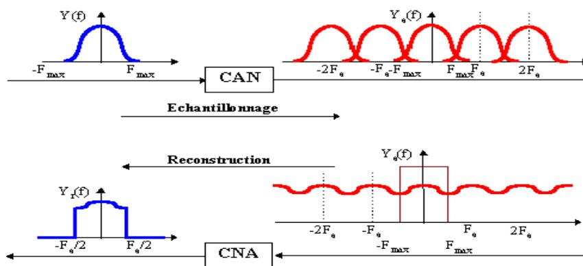
Figure (11) Echantillonnage et Reconstruction
