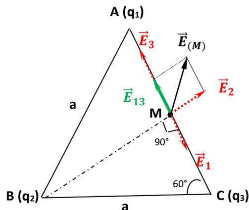
$$\vec{E}_{(M)} = \vec{E}_1 + \vec{E}_2 + \vec{E}_3 ; \quad \vec{E}_{(M)} = \vec{E}_{13} + \vec{E}_2 ; \quad \vec{E}_{13} = \vec{E}_1 + \vec{E}_3$$
