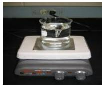
**Un agitateur :** est un élément d'une unité de procédé ayant pour but d'assurer l'homogénéisation d'un milieu (homogénéisation du point de vue des composants du milieu et/ou de la température).
