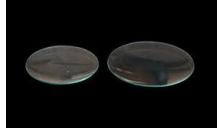
**Un verre de montre :** est un équipement de laboratoire, de forme concave, en verre. On l'utilise principalement pour couvrir un bêcher, pour évaporer un liquide.
