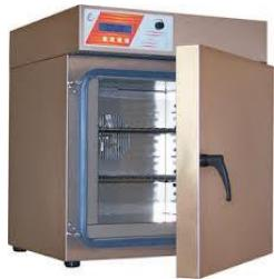
**Une étuve :** est un appareil de chauffage permettant d'effectuer divers traitements thermiques à des différentes températures.
