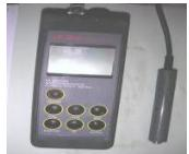
**Un conductimètre :** Appareil mesurant la conductivité.
