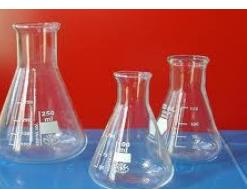
**Une erlen :** est un récipient utilisé au laboratoire. Il est constitué d'une base conique et d'un col cylindrique.
