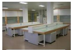
**Une paillasse:** Une paillasse de laboratoire ou une table de manipulation désigne un plan de travail dont le revêtement est par exemple carrelé, vitré, en matière plastique (résine durcie et renforcée,...) ou stratifié, afin d'en faciliter le nettoyage.
