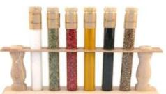
**Un tube à essai :** est un récipient utilisé au laboratoire, composé d'un tube cylindrique étroit, ouvert dans sa partie supérieure avec parfois un bord légèrement évasé, fermé par une base arrondie en forme U ou conique.
