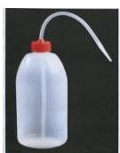
**Une pissette :** est un récipient de laboratoire, de forme cylindrique (souvent en matière plastique souple), munie d'un tube plongeant et d'un tube verseur recourbé.
