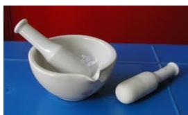
**Un mortier** : est un récipient permettant de broyer des matières que l'on veut transformer en pâte ou en poudre grâce à l'action d'un pilon. Mortier et pilon sont souvent fabriqués en bois, pierre, porcelaine, métal ou en verre.
