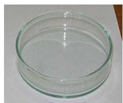
**Une boîte de Pétri** : est une boîte cylindrique transparente peu profonde, en verre ou en plastique, munie d'un couvercle. Facilement manipulable, empilable et peu coûteuse, elle est utilisée pour la mise en culture de micro-organismes, de bactéries ou de cellules d'organismes supérieurs.
