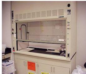
**Une hotte de laboratoire :** est un dispositif qui permet l'extraction des vapeurs toxiques des produits utilisés lors de manipulations.
