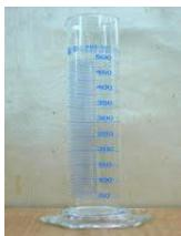
**Une éprouvette graduée :** est un récipient utilisé au laboratoire pour mesurer des volumes de liquides.
