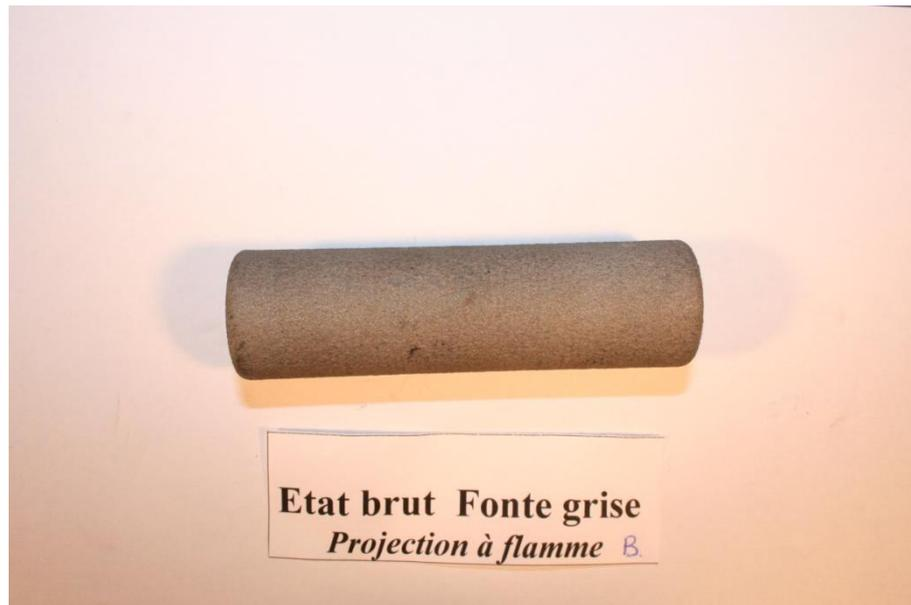
Exemple/ Echantillon en fonte grise revêtue d'une couche de molybdène utilisant la projection flamme-fil -Expérience réalisée à M.E.I M'SILA
