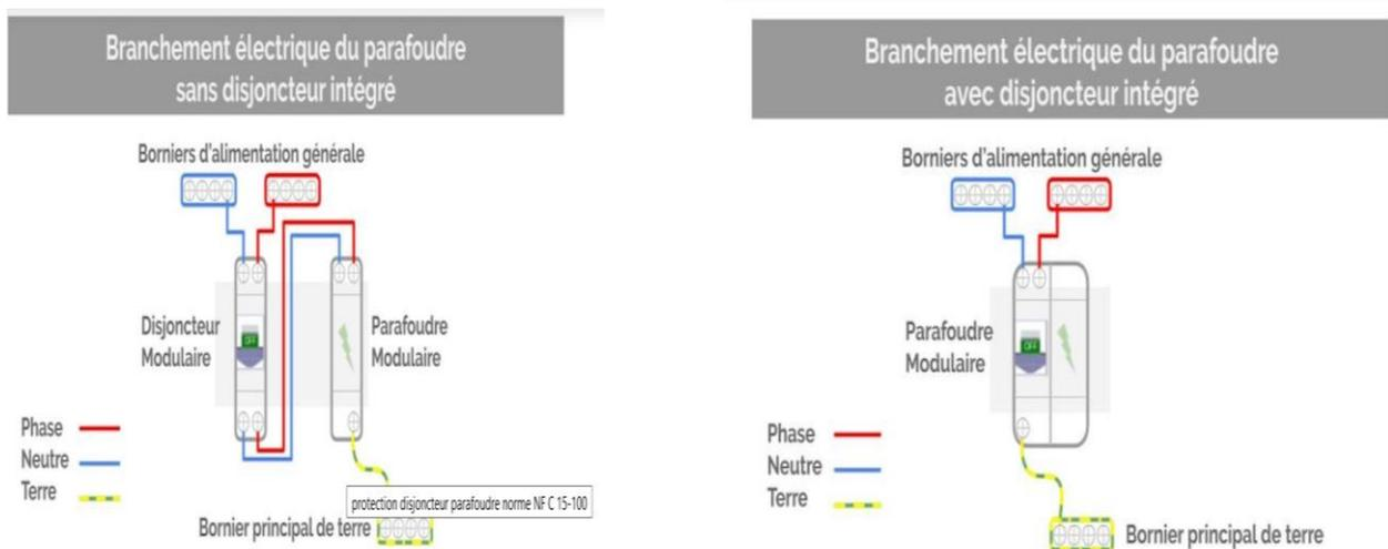
**Fig.16: Parafoudre avec et sans disjoncteur intégré**
