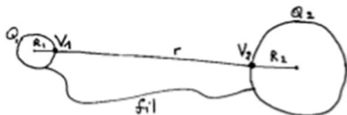
Considérons deux conducteurs sphériques de rayons  $R_1$  et  $R_2$  portant des charges  $Q_1$  et  $Q_2$ . Ces deux conducteurs sont placés à une distance  $r$  très grande devant  $R_1$  et  $R_2$ . Ils sont reliés par un fil conducteur portant une charge négligeable, ils se trouvent donc au même potentiel électrique.
