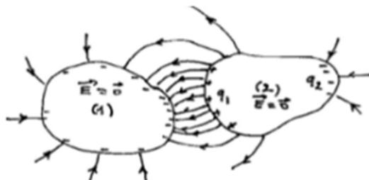
Les charges dans le conducteur isolé (2) se séparent et se répartissent comme le montre la figure. Si le conducteur est neutre, on aura  $q_1 + q_2 = 0$ , s'il porte une charge  $q_0$ , on aura  $q_1 + q_2 = q_0$ .
