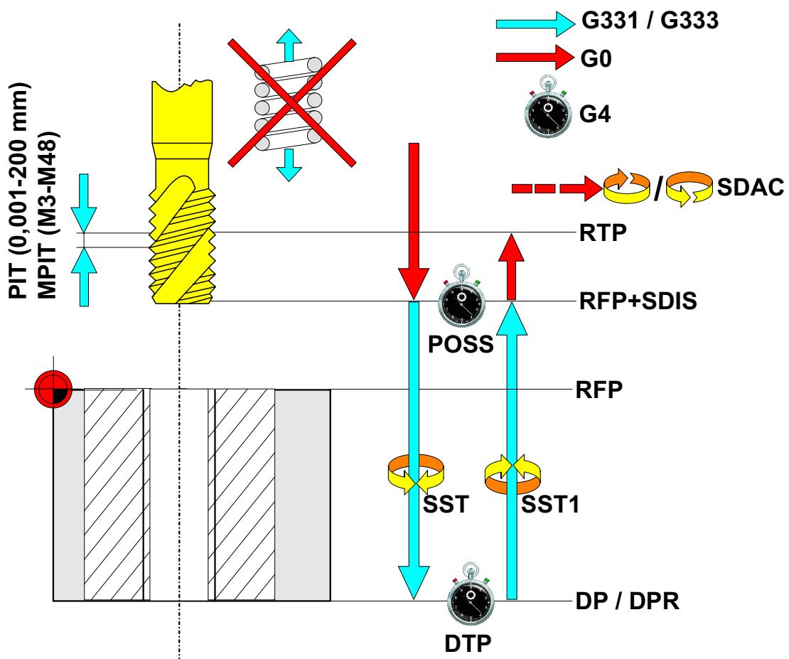
N0100 CYCLE 84 (RTP,RFP,SDIS,DP,DPR,DTP,SDAC,MPIT,PIT,POSS,SST,SST1)
