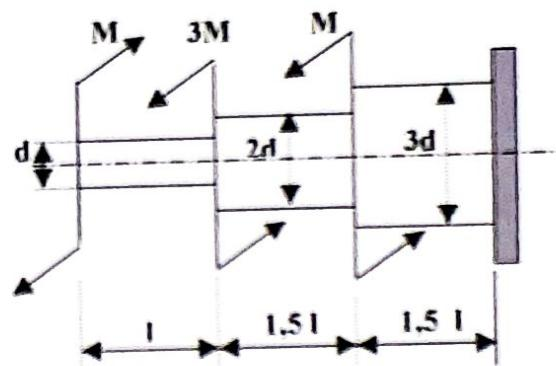
**Exercice 3 :** Déterminer les dimensions des sections droites des barres assurant leurs résistances et calculer leurs angles de torsion.
