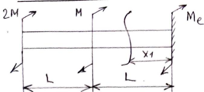
lorsque l'on nous demande de calculer l'angle de torsion  $\alpha$  on doit toujours commencer du côté de l'encastrement car on sait que  $\alpha$  est nul à l'encastrement.
