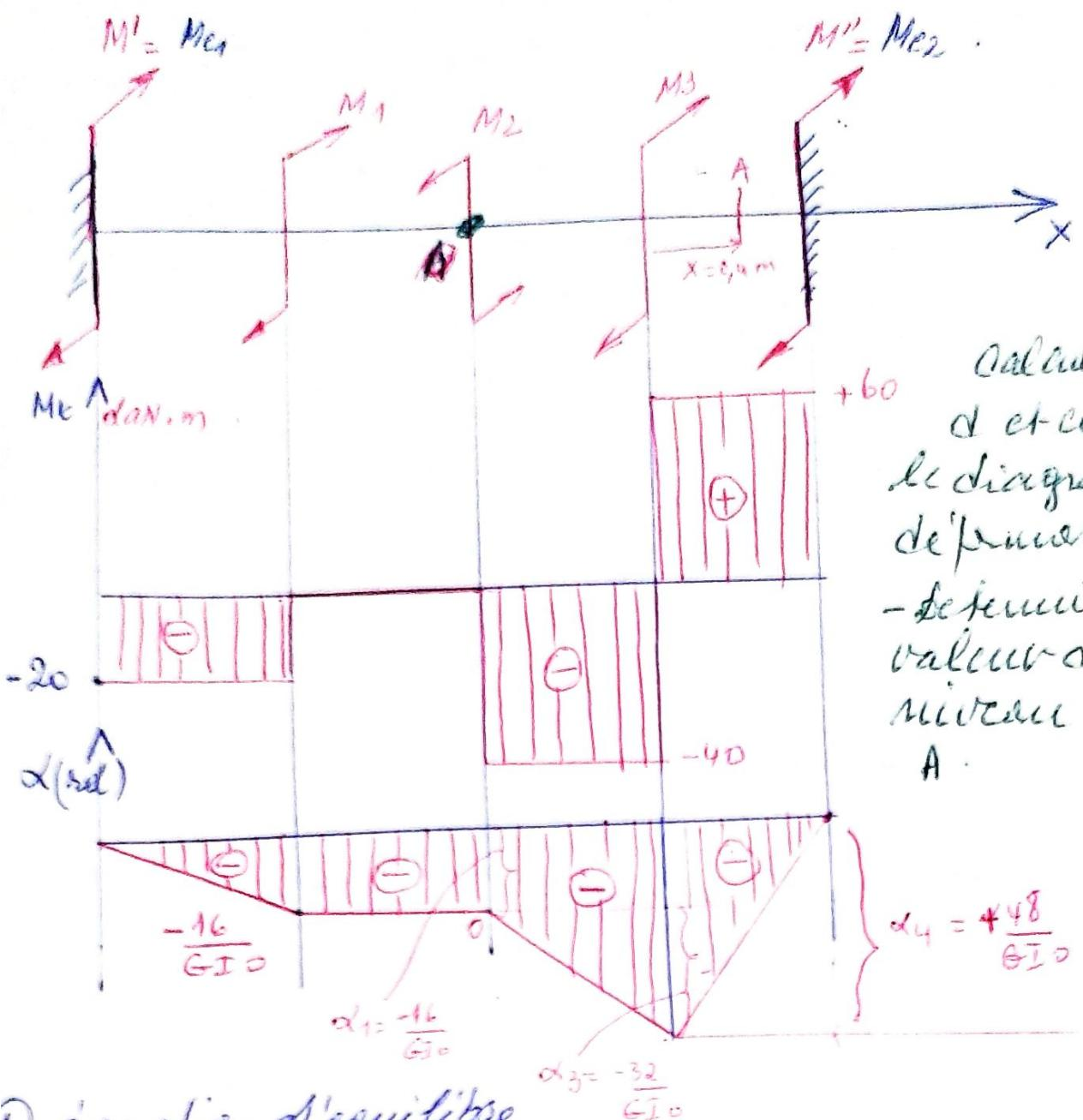
Calculer le diamètre d et construire le diagramme de déflexion d.
