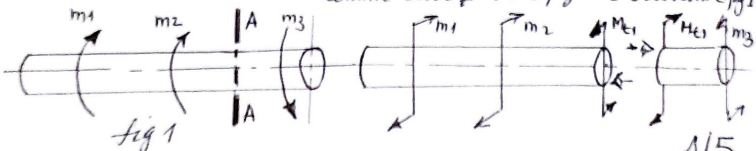
Des que vous faites la section (tronçon) vous devez représenter les moments de torsion  $M_t$  dans le sens que j'ai présenté sur la fig(1). on doit pas changer de sens (convention de flèche).
