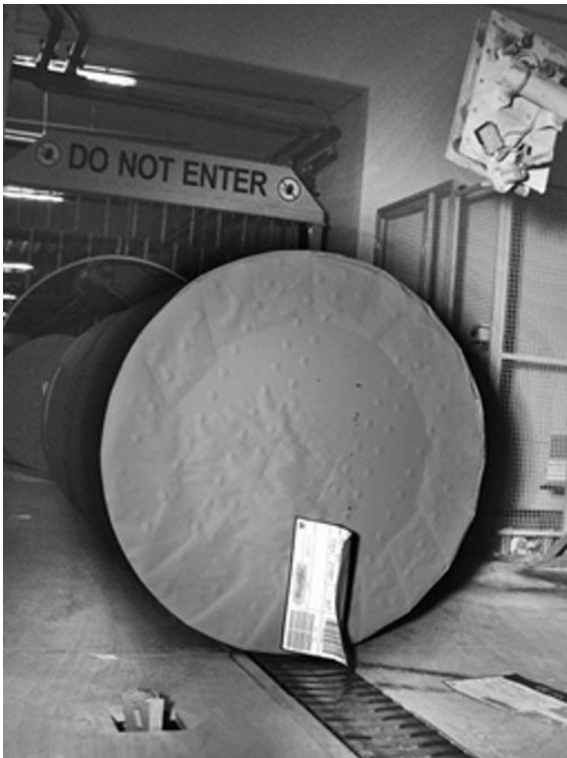
Exemple d'erreur détectée : l'étiquette a glissé. Image source : Roptec GmbH
