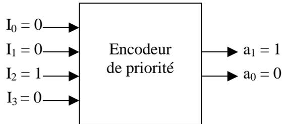
Le SN74LS348 est un exemple d'encodeur à 8 entrées. L'ordre de priorité va de l'entrée 7 vers l'entrée 0. Les sorties GS et EO et l'entrée EI servent à mettre en cascade plusieurs encodeurs. Les entrées et les sorties sont actives à 0.
