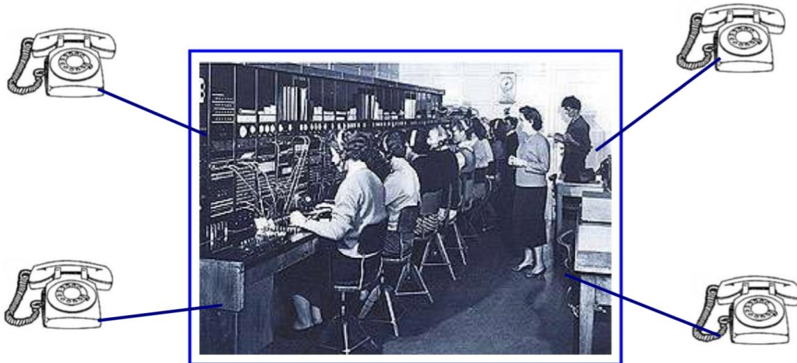
**Figure 7.** La commutation manuelle avant les CAA
