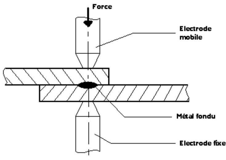
Il existe de nombreuses variantes à cette technique de soudage tel que le soudage par molette qui est une variante du précédent, ici les électrodes sont remplacées par des molettes tournantes ce qui permet un soudage continu ou discontinu très rapide.
