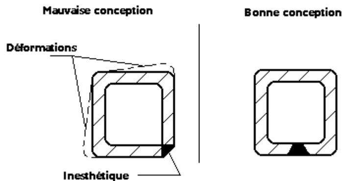
Règle 4 : Afin d'augmenter la longévité des outils, éviter d'usiner une soudure.
