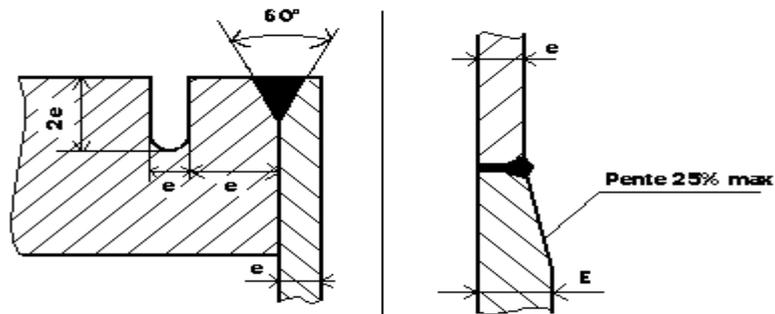
Règle 2 : Placer la soudure dans les zones les moins sollicitées. Eviter, en particulier, les sollicitations en flexion et en torsion.
