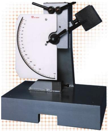
Essais de la résistance à la fracture de matériaux plastiques. Une seule frappe du marteau du balancier fracture l'éprouvette. La sécurité est assurée par une protection intégrée, par le verrouillage du balancier, et par le mécanisme de déclenchement de l'essai par l'opérateur, à deux mains.
