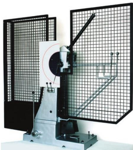
Un mécanisme d'essais au choc à balancier pour essais Charpy et Izod.
