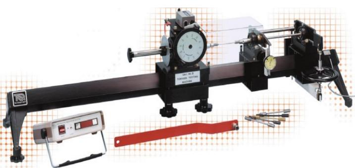
La Machine d'Essais de Torsion (30Nm) mesure le couple de torsion et les déformations d'éprouvettes métalliques. Met en évidence plusieurs propriétés des matériaux, ainsi que leur comportement. Les charges peuvent être appliquées dans les deux sens de rotation, sur éprouvettes de longueurs différentes. Un couple-mètre numérique permet une lecture rapide et aisée. Un torsiomètre, disponible en option, permet d'augmenter la précision de lecture de la déformation
