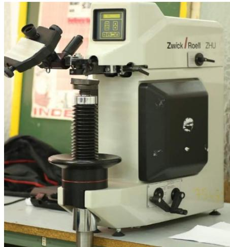
Duromètre Universel INDENTEC type 8187.5 LKV de Zwick.
