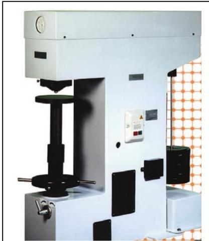
Machine d'Essais de Dureté Brinell
