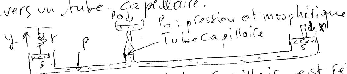
Le débit d'huile dans ce tube capillaire est régi par la loi de Poiseuille : il est proportionnel à la différence de pression d'huile de 2 extrémités :
