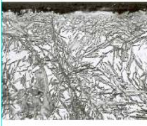
Figure 18a. Couche de martensite présence d'austénite résiduelle
