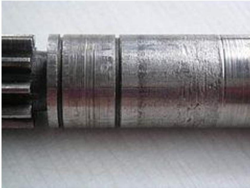
**Figure 4. Schéma d'un tourillon qui porte diverses traces d'usure [3]**
