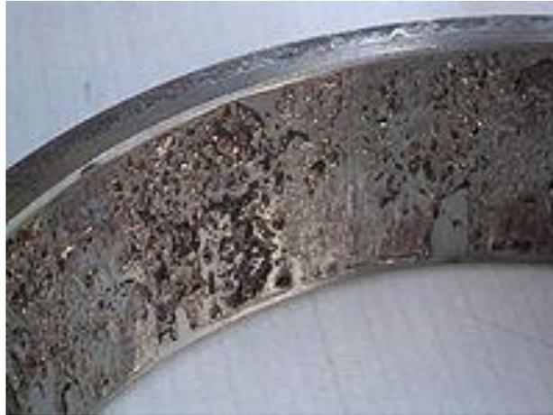
**Figure 8. Écaillage d'une bague extérieure d'un roulement à rouleaux cylindriques [3].**
