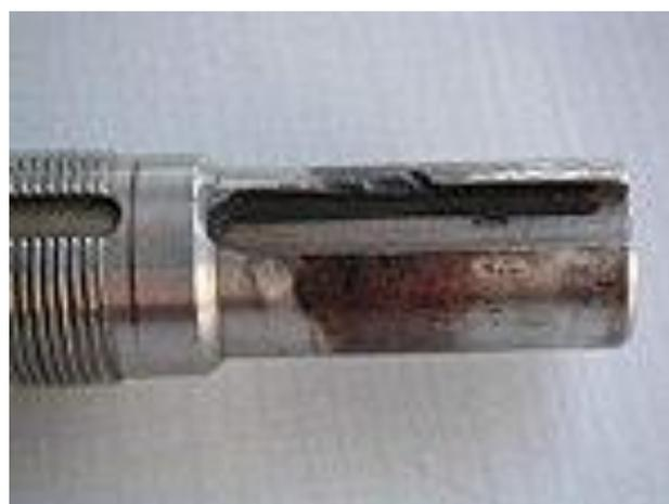
**Figure 7. Corrosion en bout d'arbre [3]**
