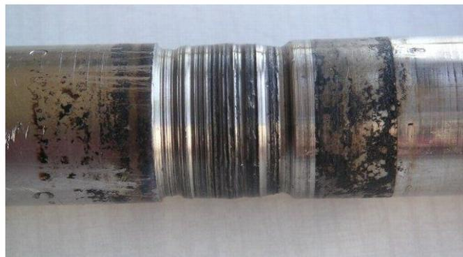
**Figure 5(a,b,c) . Exemples de pièces mécaniques ayant subi une usure par abrasion [3].**
