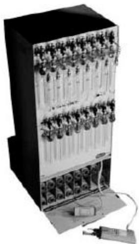
Échantillonneur automatique 16 postes pour analyse des COV en mode « Purge & Trap », placé en amont de l'appareillage de la figure 13.
