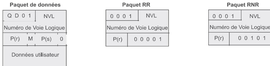
Figure 14.18 Format des paquets de données, d'acquittement et de contrôle de flux.
