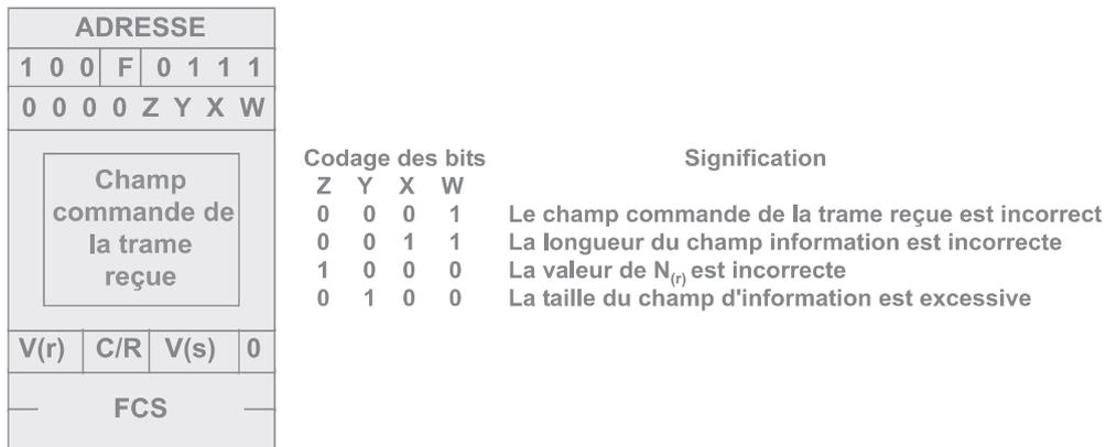
Figure 14.9 La trame d'indication d'erreurs FRMR.
