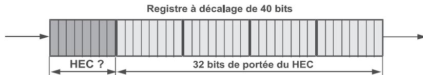
Figure 14.50 Principe du repérage du HEC.
