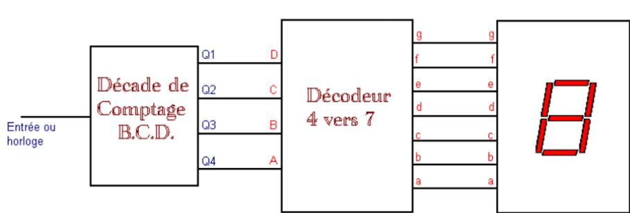
Fig. 5.4 Décodeur nécessaire pour commander un afficheur à 7 segments
