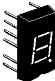
Fig. 5.2 l'afficheur sept segments dans son boîtier
