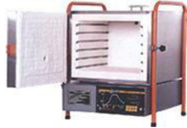
1) Après séchage première cuisson à  $980^{\circ}$  dans un four électrique "dégourdie" la pièce est déshydratée
