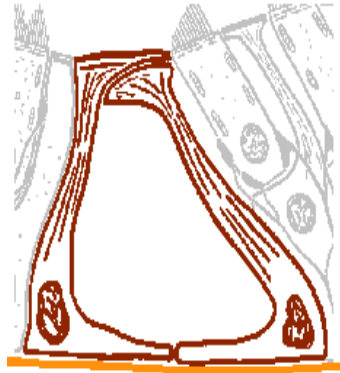
Figure 5 : les piliers du tunnel
