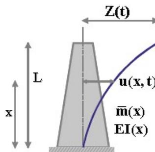
Fig. 1. Poutre Console
