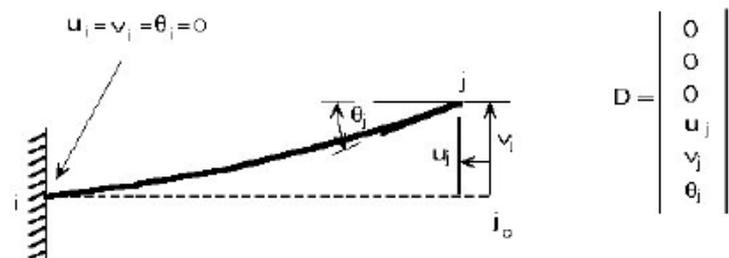
Figure 2. Poutre Console
