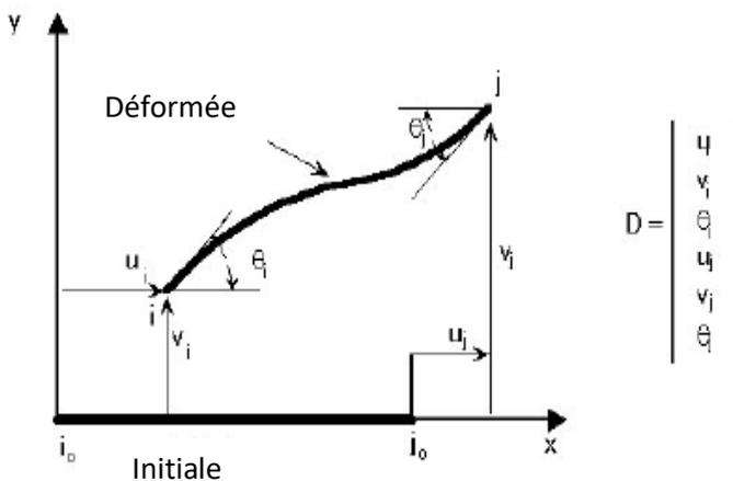
Figure 1. Poutre Généralisée
