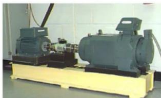
Figure: Stand experimental pour l'analyse vibratoire
