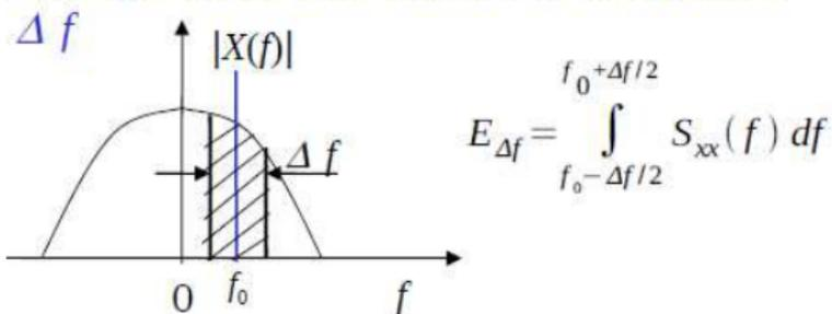
Figure: Energie dans une sous-bande fréquentielle
