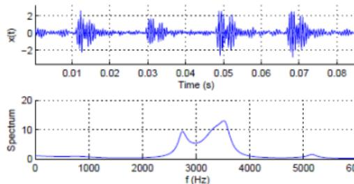
Figure: Défaut de roulement
