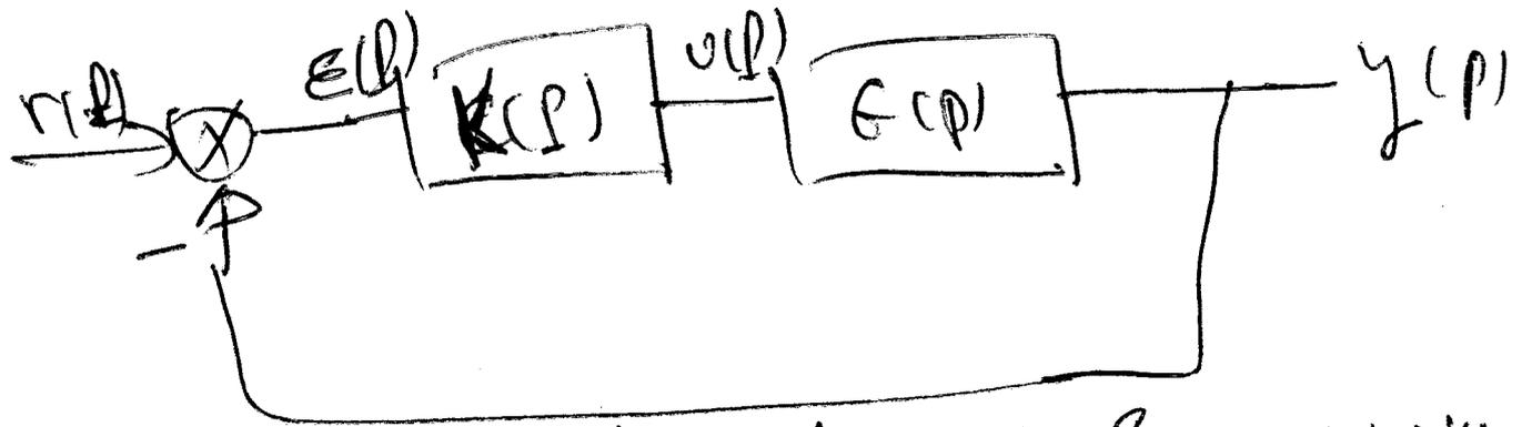
déterminer  $K(p)$  à partir de la connaissance de  $G(p)$  et de spécifications sur les performances (temps de réponse bande passante) tout en assurant l'instabilité du système en boucle fermée.
