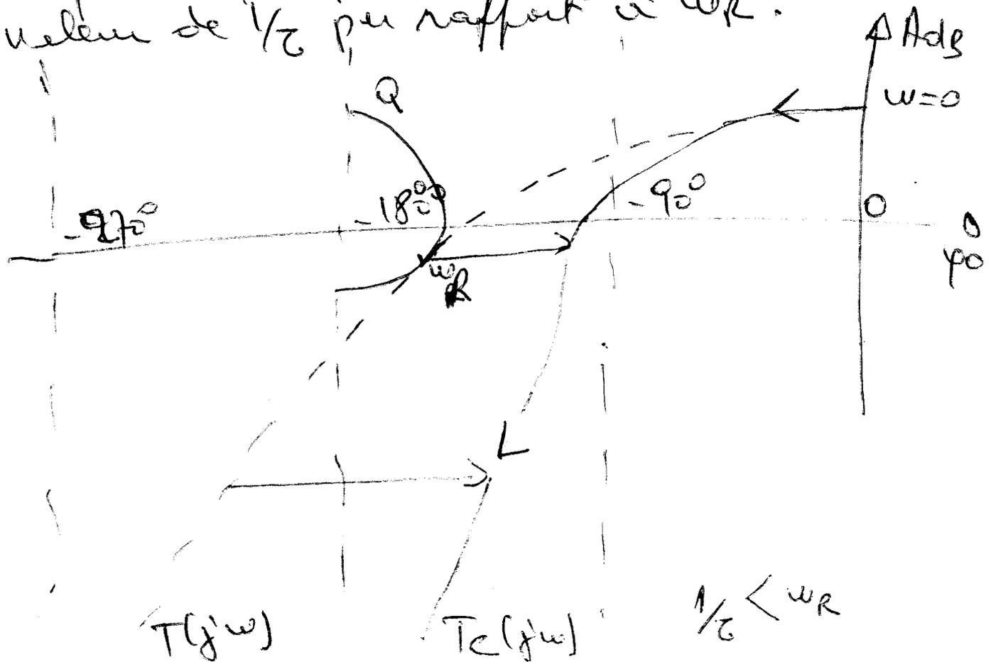
les flèches représentent le vecteur  $K(j\omega)$  pour une valeur particulière de la pulsation  $\omega$ . pour retrouver, avec le système corrigé, le degré de stabilité du système non corrigé on voit sur la figure précédente qu'il faut re-
