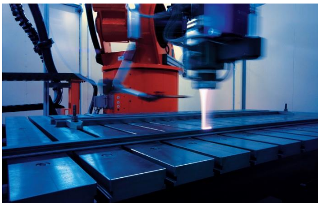
Figure 4(a,b). a) Installation du procédé de la trempe par chauffage à laser [5].
