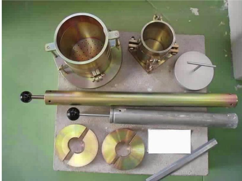
**Fig 6 appareillage de compactage.**
