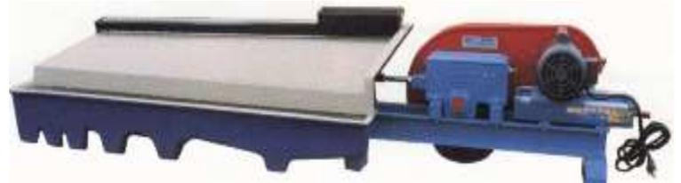
La hauteur des cannelures décroît vers l'extrême plus éloigné pour permettre un certain nettoyage des particules attrapées à l'intérieur: celles placées au dessus de la couche de particules, à cause de leur densité plus faible, seront entraînées par l'eau de lavage, étant ainsi séparées de celles situées plus au fond, celles-ci étant plus lourdes.
