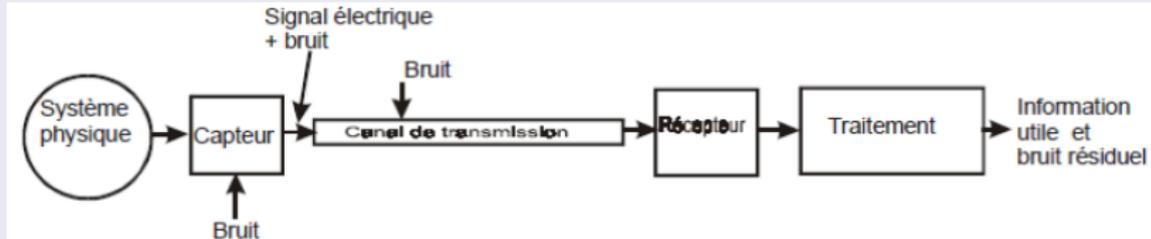
Figure: Chaîne de transmission d'un signal analogique
