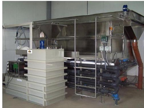
À la sortie d'un flottateur les eaux sont quasiment dépourvues de matières en suspension ; reste tout de même certains polluants solubles non-affectés par la coagulation-floculation et il est nécessaire de mettre en place une deuxième étape de traitement d'eau du type : filtration sur charbon actif, ozonation et autre...
