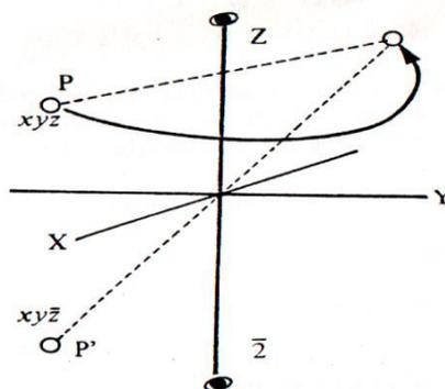
Fig.III-7 : Représentation graphique d'une roto-inversion  $\bar{2}$
