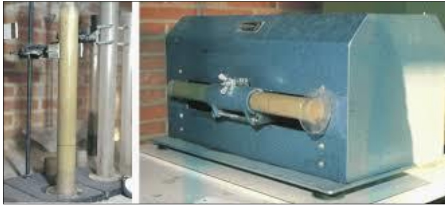
Fig5 : Essai Equivalent de sable
