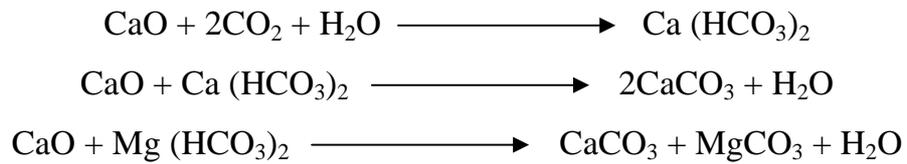
L'élimination de la dureté bicarbonate calcique ou magnésienne s'effectue par la formation de précipités de carbonate de calcium et de magnésium.
