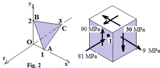
La figure 2 présente un système d'axes sous lequel l'état de contrainte en un point I du matériau est donné. Un plan ABC est aussi spécifié.
