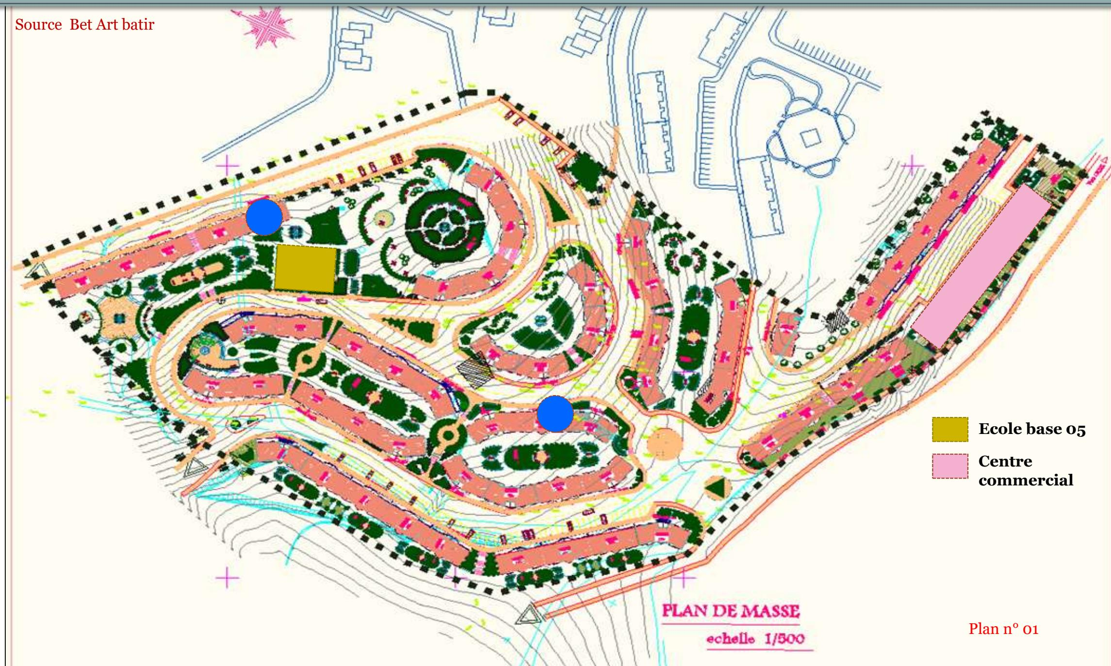
**Le sol**, suivant l'étude de sol établie par le laboratoire LNHC et suite au points de sondage effectuée sur les points désignées sur le plan n° 01 le terrain est constitué essentiellement par des altérations de schistes sous forme d'argile sablo-limoneuse graveleuse dont la contrainte est de 1.2-----1.8 bars
