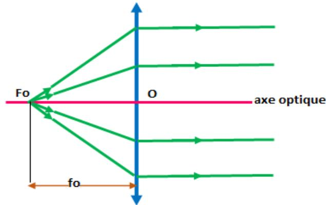
La distance focale est la distance entre le foyer et le centre de la lentille. On la note  $f_o$  et s'exprime en mètres. De même la distance focale image est la distance entre le centre optique et le point focal image ( $F_i$ ).
