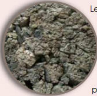
Le liège pur expansé est issu de l'arbre chêne-liège. Le liège est résistant à la compression et indéformable. Ni les rongeurs ni les insectes ne l'apprécient. Le liège est également un très bon isolant phonique. Les plaques de liège expansé se posent et se découpent facilement.
