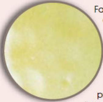
Fabriqué au départ sous forme de mousses. Celles-ci sont obtenues à l'aide de catalyseurs et d'agents propulseurs à base d'isocyanates, avec des adjuvants pour stabiliser ou pour ignifuger. Ce sont des mousses à cellules fermées et peu compressibles.
