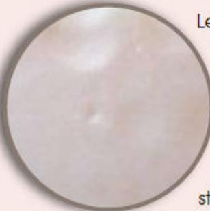
Le polystyrène expansé est fabriqué au moyen d'hydrocarbure (styrène) expansé à la vapeur d'eau et présente donc une structure à pores ouverts.
