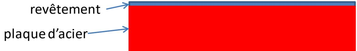
Un revêtement doit être appliqué sur une plaque d'acier de sorte à ralentir la corrosion. Le revêtement présente un coefficient de dilatation thermique de  **$10 \times 10^{-6} \text{ cm/cm}\cdot^{\circ}\text{C}$** , une résistance de **25 MPa** et un module élastique de **100 GPa**.
