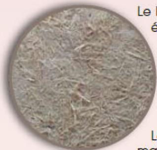
Le bois comme isolant se présente également sous différentes formes : laine de bois (panneau semi-rigide, en vrac...), panneau de fibres de bois rigides ou encore des fibraglos (fibres de bois avec enrobage de plâtre et ciment).
