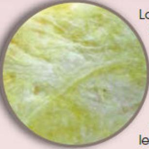
La laine de verre est fabriquée au moyen de verre de récupération et de sable siliceux et obtenue par fusion de ces matières à environ 1 500 °C.
