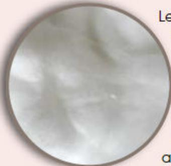
Le coton est originaire de Chine. La fibre de coton est utilisée comme matériau isolant depuis une quinzaine d'années. Les fibres ne reçoivent aucun traitement chimique, elles sont simplement cardées et reçoivent un traitement ignifugeant au sel de bore.
