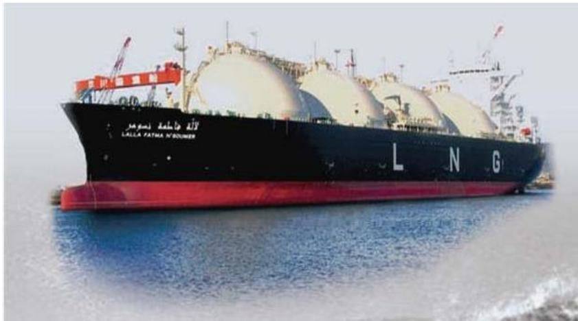
**Fig. 4.7** Méthanier à cuves autoporteuses
