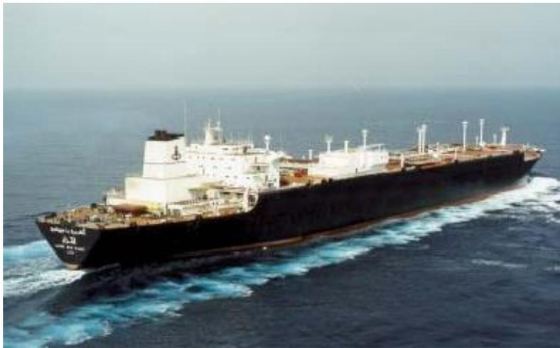
**Fig. 4.6** Méthanier à cuves intégrées
