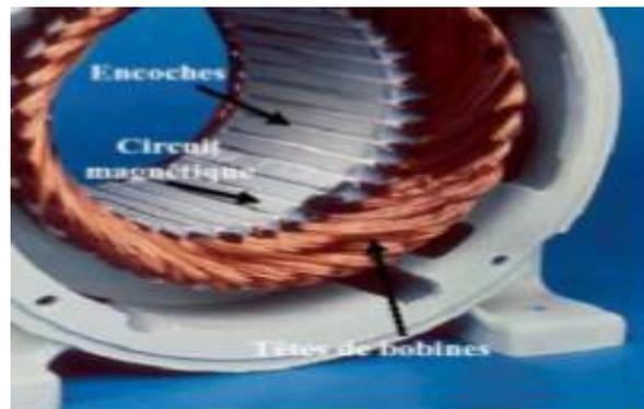
Fig. 3. Photo du stator d'un moteur asynchrone à cage
