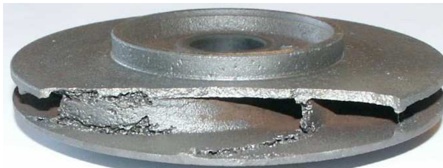
Roue érodée de la pompe à cause de la cavitation
