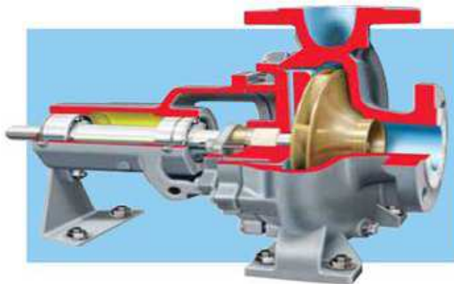
Pompe radiale (centrifuge pure)
