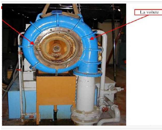
Fig. 3 Constitution d'une pompe centrifuge
